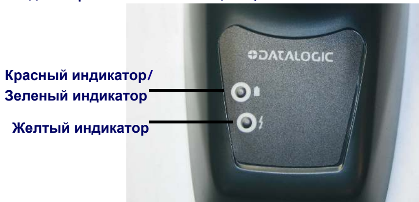
Рис. 1. Индикаторы на базовой станции QuickScan
