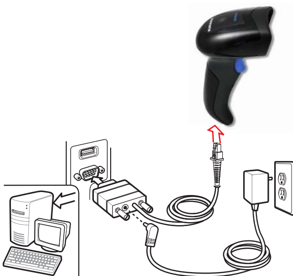
Рис. 3. Подключение по интерфейсу RS-232
